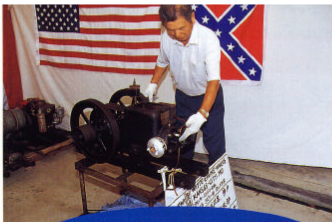
●手慣れた作業でウィットニーを始動させる大山氏。左手で吸気レベルを加減しながら上死点を探し、右手で一気にはフライホイールを回す。その作動音はあくまで耳に優しく心地良い。
