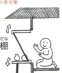
板戸の表裏に格子の組子がついた建具 開く際は上方向へ跳ね上げて、吊り金具で引っ掛けて固定 開放的ではあるものの、開け閉めがかなりの重労働
