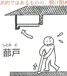
板戸の表裏に格子の組子がついた建具 開く際は上方向へ跳ね上げて、吊り金具で引っ掛けて固定 開放的ではあるものの、開け閉めがかなりの重労働
